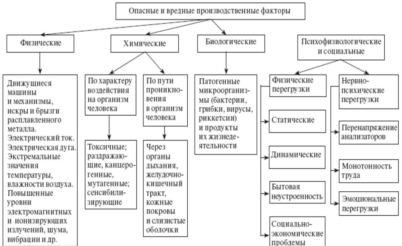
Рис. 1.2. Опасные и вредные производственные факторы
