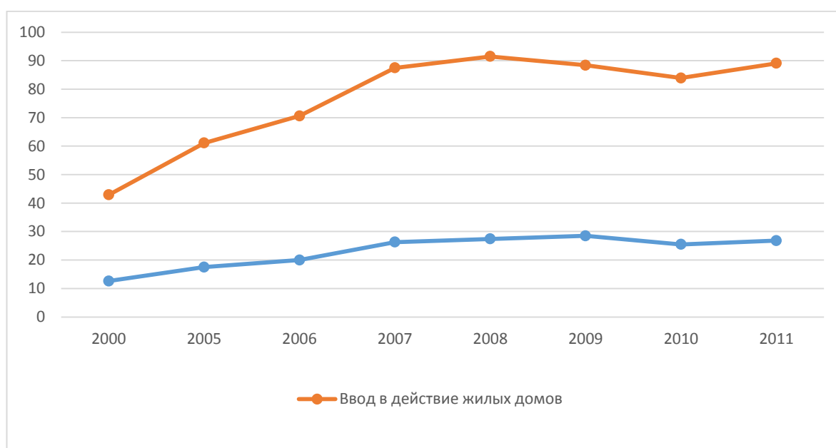
Рис.1. Ввод в действие жилых домов и индивидуальных жилых домов, построенных населением РФ за счет собственных и заемных средств (2000–2011 гг., млн. м 2 )
