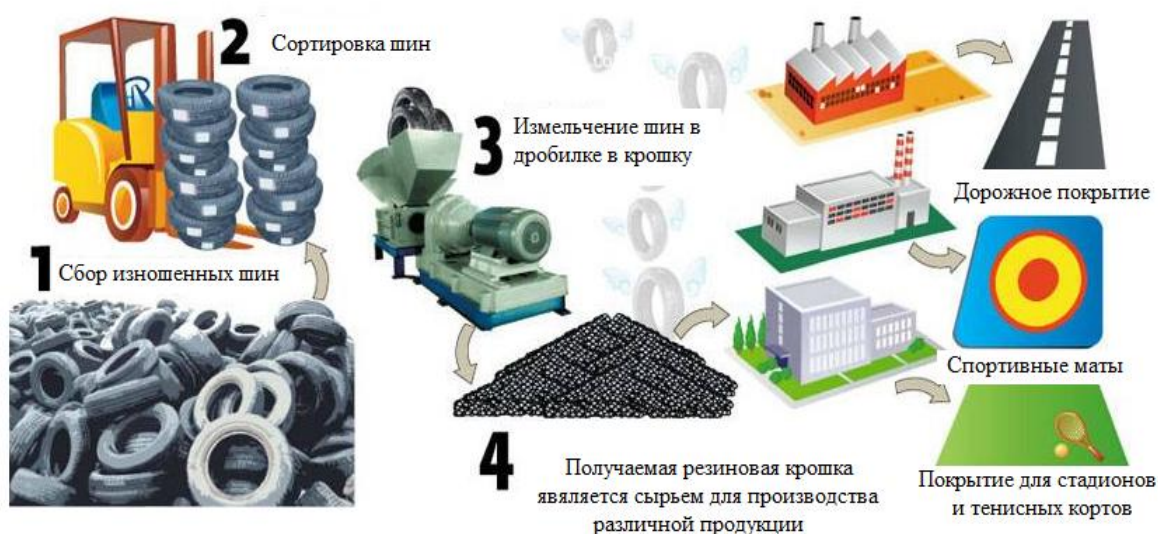
Рис. 2.1. Технологическая схема переработки шин
