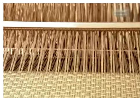
Рис. 14. Ткацкий станок
