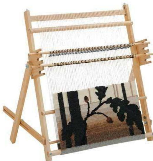
Рис. 22. Гобеленовый ткацкий станок
