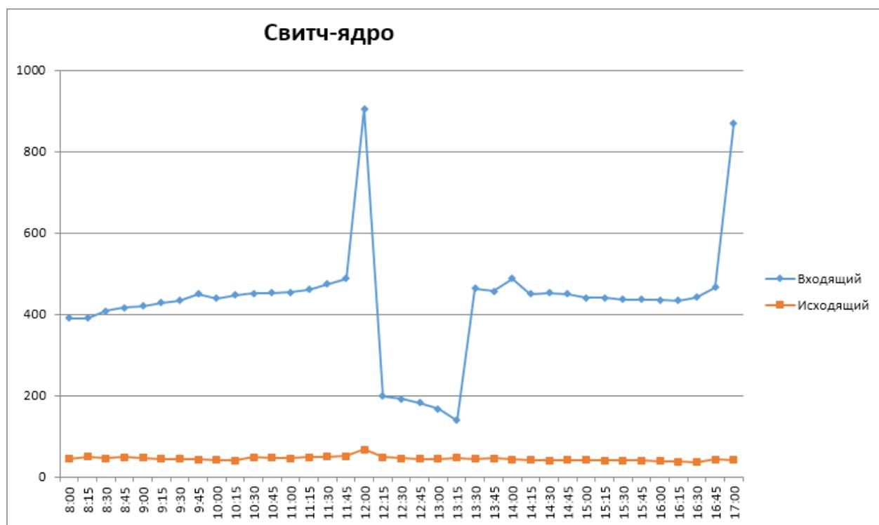
Рисунок 2.6 – Нагрузка на канал свитча-ядра
