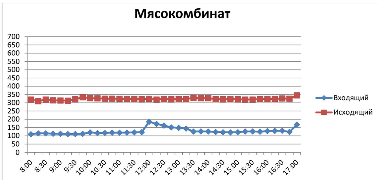
Рисунок 3.2 – Нагрузка на канал «Мясокомбината» при использовании маршрутизатора
